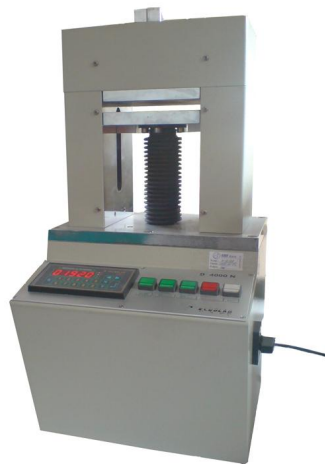
Slika 17. Višenamjenski uređaj za ispitivanje otpornosti papira prema pritisku (CMT)– ispitivanje papira i papira za val –flutinga
