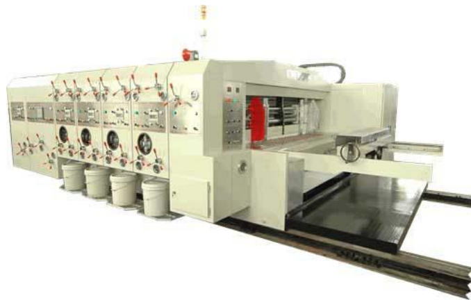
Slika 11. Sloter sa tiskovnom jedinicom
