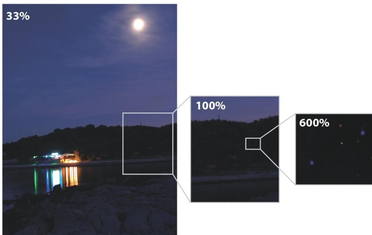
Slika 2.14.: Primjer nastajanja šuma prilikom duge ekpozicije – ekspozicija 20 sec, f 4.3, ISO100
