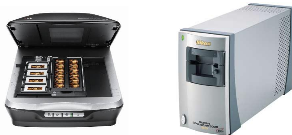
Slika 2.3.: Prikaz plošnog skenera sa mogućnosti skeniranja filma i skener za film (slike preuzete sa http://www.hardwarecentral.com/reviews/article.php/3844636/Epson-Perfection-V500-Office-Color-Scanner-Review.htm i http://www.pcpres.rs/arhiva/tekst.asp?broj=109&tekstID=5671 )
