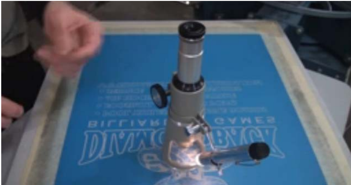
Slika 14. Uređaj za detaljan pregled snimljenog sita
