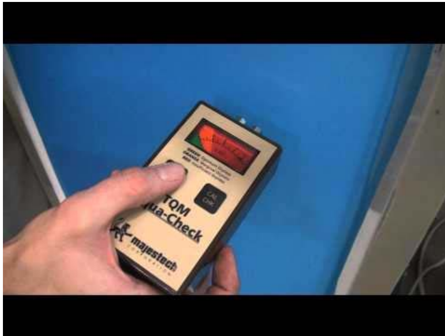
Slika 12. Uređaj za ispitivanje suhoće emulzijskog sloja na situ
