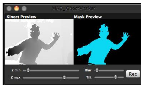
Slika 17. Prikaz izrade maske u realnom vremenu pomoću Kinect kamere
