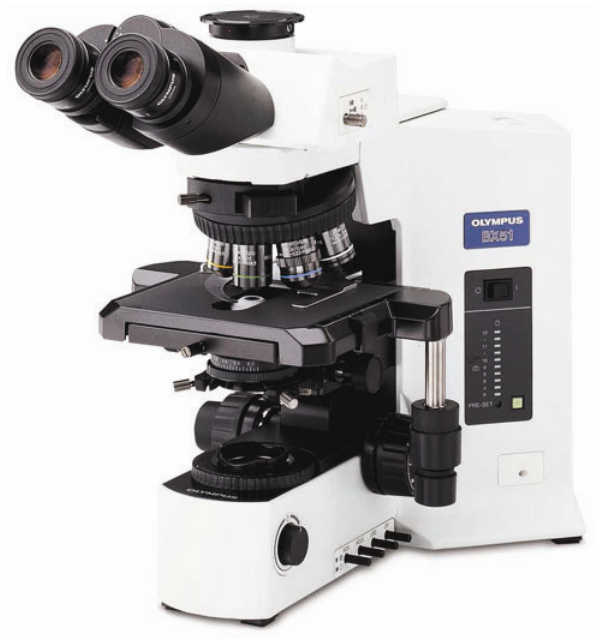
Slika 22. Mikroskop Olympus BX 51 (izvor: http://forum.mikroskopia.com/topic/5250-olympus-bx51/ )
