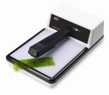
Slika 20. VipFLEX, uređaj za mjerenje razine kvalitete tiskovne forme (izvor: http://www.colour-control.com/farbmessung/druckplattenmessgeraet/vipflex/vipflex_de.htm )
