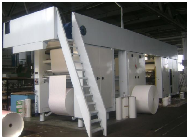
Slika 16. Stroj za tisak MASTERFLEX 1020
