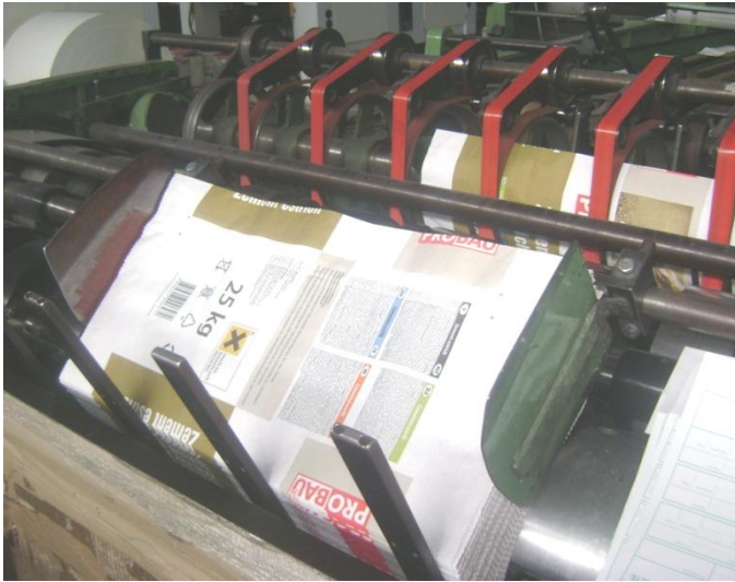
Slika 19. Ulagači dio ventil stroja
