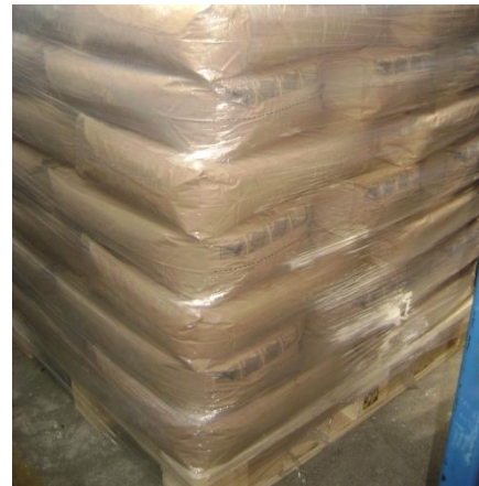
Slika 4. Paletizirane, napunjene ventil vreće
