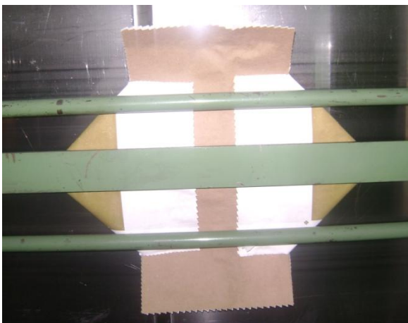
Slika 21. Otvoreno dno prije nanosa ljepila
