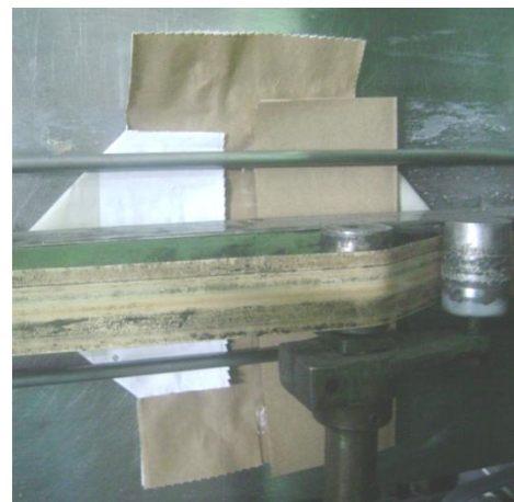
Slika 22. Umetanje papira za ventil
