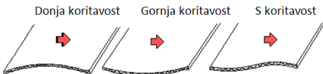
Slika 15. Oblici koritanja u smjeru toka proizvodnje
