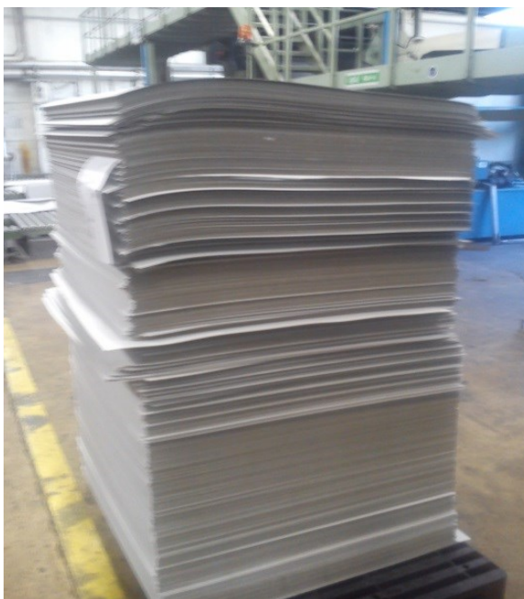
Slika 18. S koritavost na kartonskim pločama E vala
