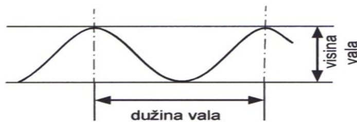
Slika 6. Prikaz mjera za dužinu i visinu vala
