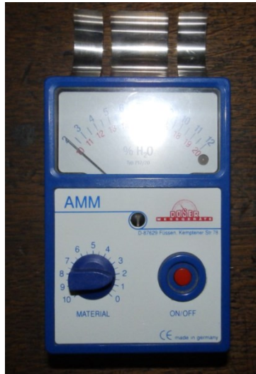
Slika 21. Higrometar korišten za mjerenje vlage u rolama papira
