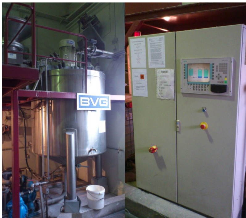
Slika 8. Lijevo – spremnik za pohranu i miješanje ljepila, desno – zaslon na kojem se kontroliraju parametri ljepila
