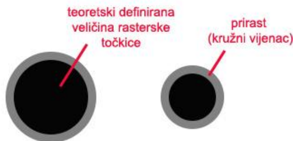
Slika 9. Prirast rasterskog elementa
