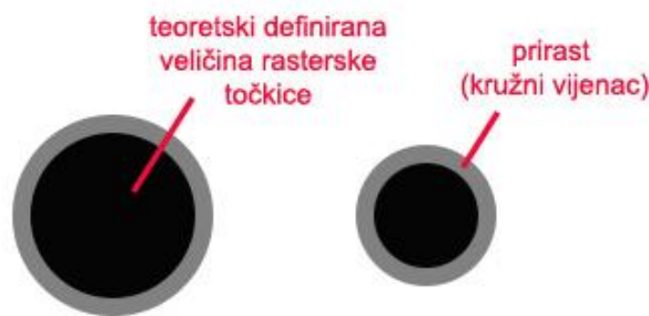
Slika 9. Prirast rasterskog elementa
