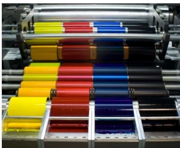
Slika 5. Prikaz bojila na valjcima za obojenje
