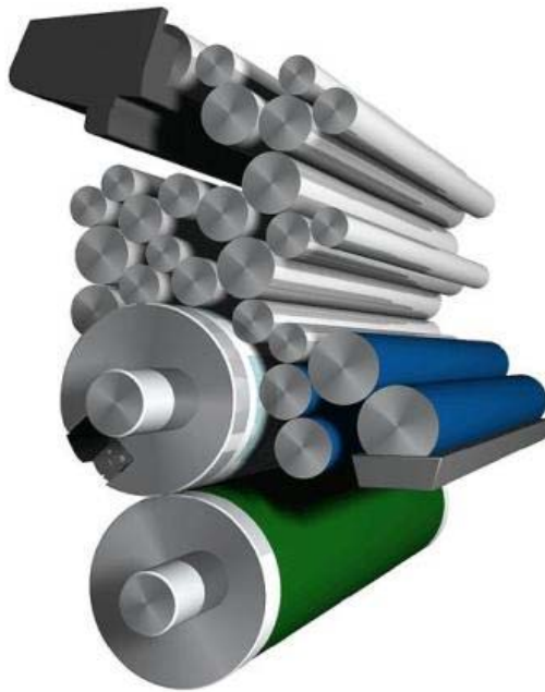
Slika 4. Shema uređaja za vlaženje (Alcolor)
