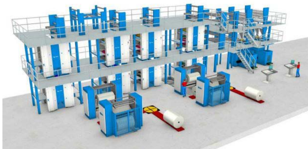
Slika 2. König-Bauer stroj za novinski tisak (etažni)
