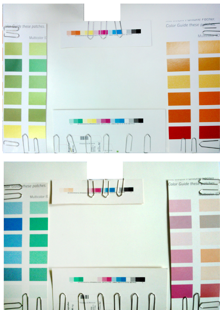
Slika 23. Pripremljene forme za Solarbox prije (gore) i poslije (dolje) postupka ubrzanog starenja
