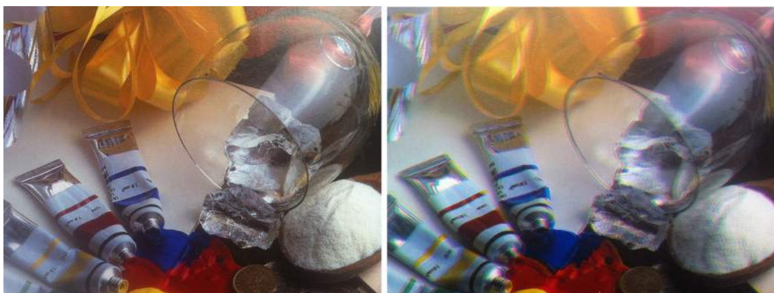
Slika 5. Problem lošeg pasera na otisku (Zjakić I. (2007). Upravljanje kvalitetom ofsetnog tiska , Hrvatska sveučilišna naklada, Zagreb)
