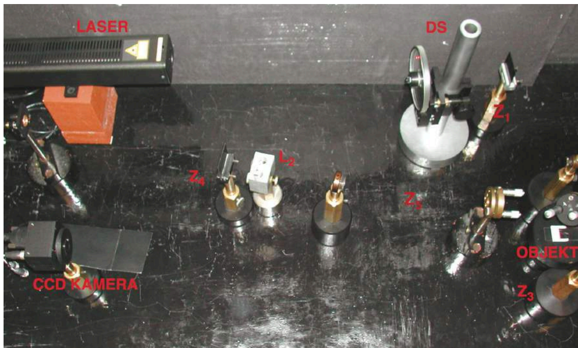
Slika 15. Postav elemenata za snimanje holograma
