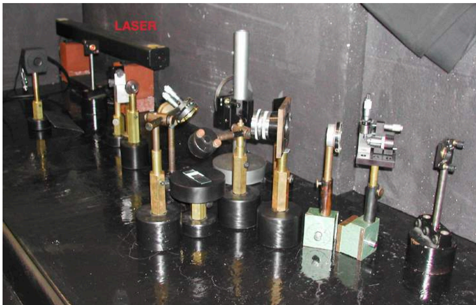
Slika 13. Laser i njegov položaj pri snimanju interferograma
