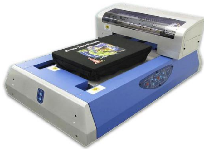
Slika 12 DTG pisač FreeJet 320 TX ( http://202.67.224.134/pdimage/32/3636632_frejettx330.jpg )
