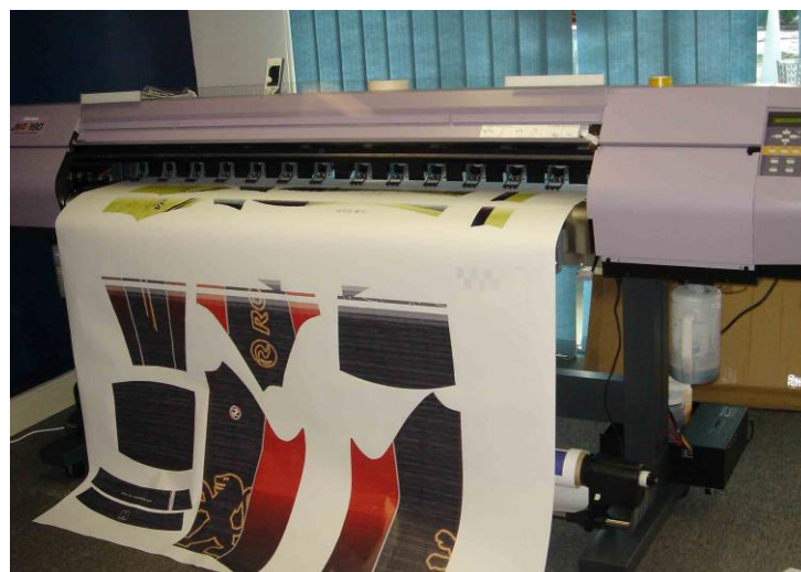
Slika 7 Primjer sublimacijskog tiska ( http://www.hiwtc.com/photo/products/30/01/05/10552.jpg )
