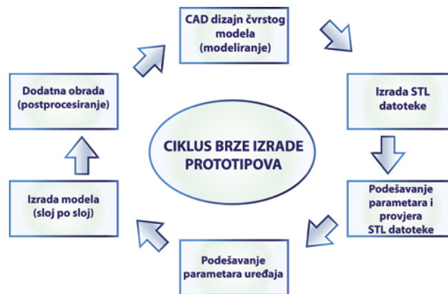
Slika 3. Ciklus brze izrade prototipa
