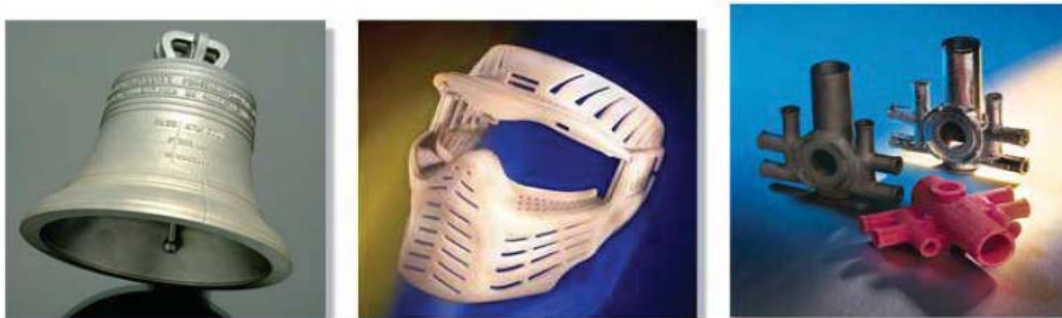
Slika 11. Modeli nastali primjenom SLS tehnologije [1]
