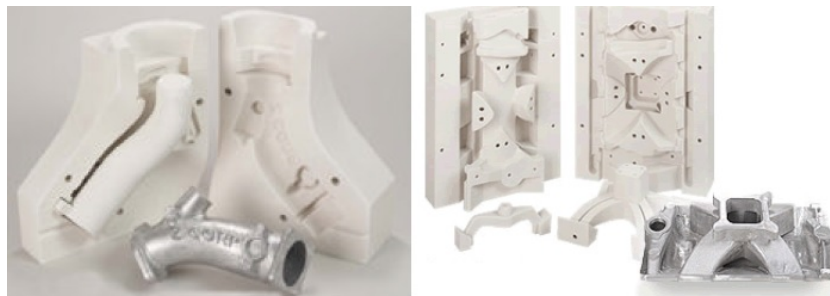
Slika 14. Modeli nastali Z-cast metodom [3]
