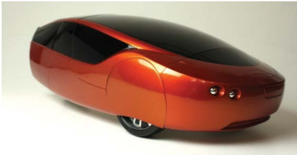
Slika 20. The Urbee - prototip automobila sa komponentama isprintanim 3D tehnologijom tiska [4]
