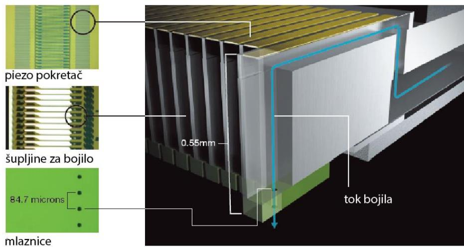
Slika 9. Glavne komponente PrecisionCore ispisnog čipa (Izvor:
