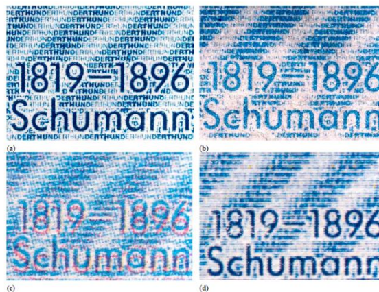
Slika 37. Original i krivotvorine mikroteksta (100 DEM)
