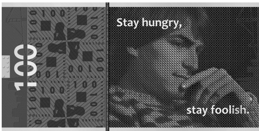
Slika 123. Izgled lica novčanice u IR spektru
