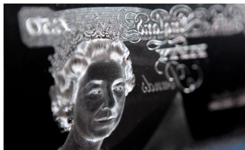
Slika 31. Tiskovna forma intaglio tehnike - britanska funta (1994.g.).
