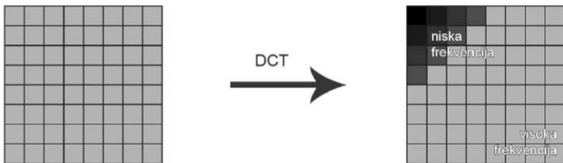
Slika 7. Proces kompresije diskretnom kosinusnom transformacijom [9]
