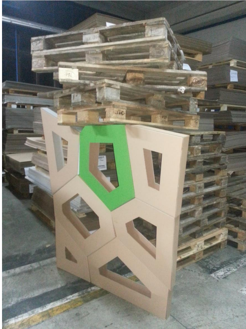
Slika 40 - Testiranje novih elemenata i njihove nosivosti. Rješenje je nastalo oko 3 ujutro, nakon sastavljanja, i postavljanja paleta koje su vršile opterećenje, elementi su ostavljeni, u periodu od oko 8 sati pod opterećenjem. Eksperiment je završio popuštanjem jednog od elemenata na dnu (na slici veći, desni) jer je isti bio izrezan s krivim smjerom vala. Smjer vala bio je paralelan sa tlom. Nakon rasapda strukture utvrđeno je potpuno uništenje samo tog „krivo izrezanog“ elementa.
