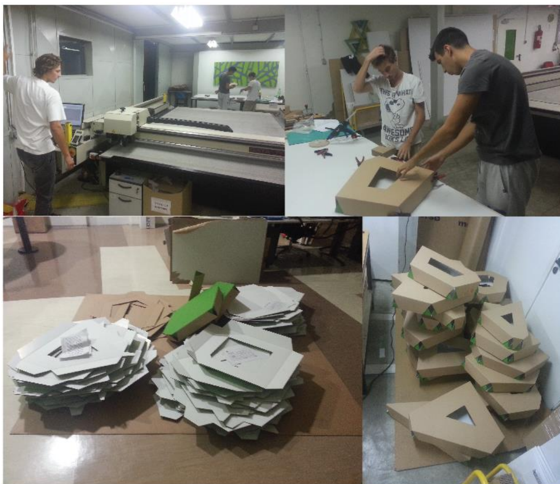
Slika 42 - proces izrade kutija. Izrezivanje, ljepljenje i slaganje za transport.
