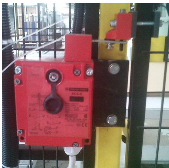
Slika 13 Vrata koje kontrolira elektromehanički granični prekidač
