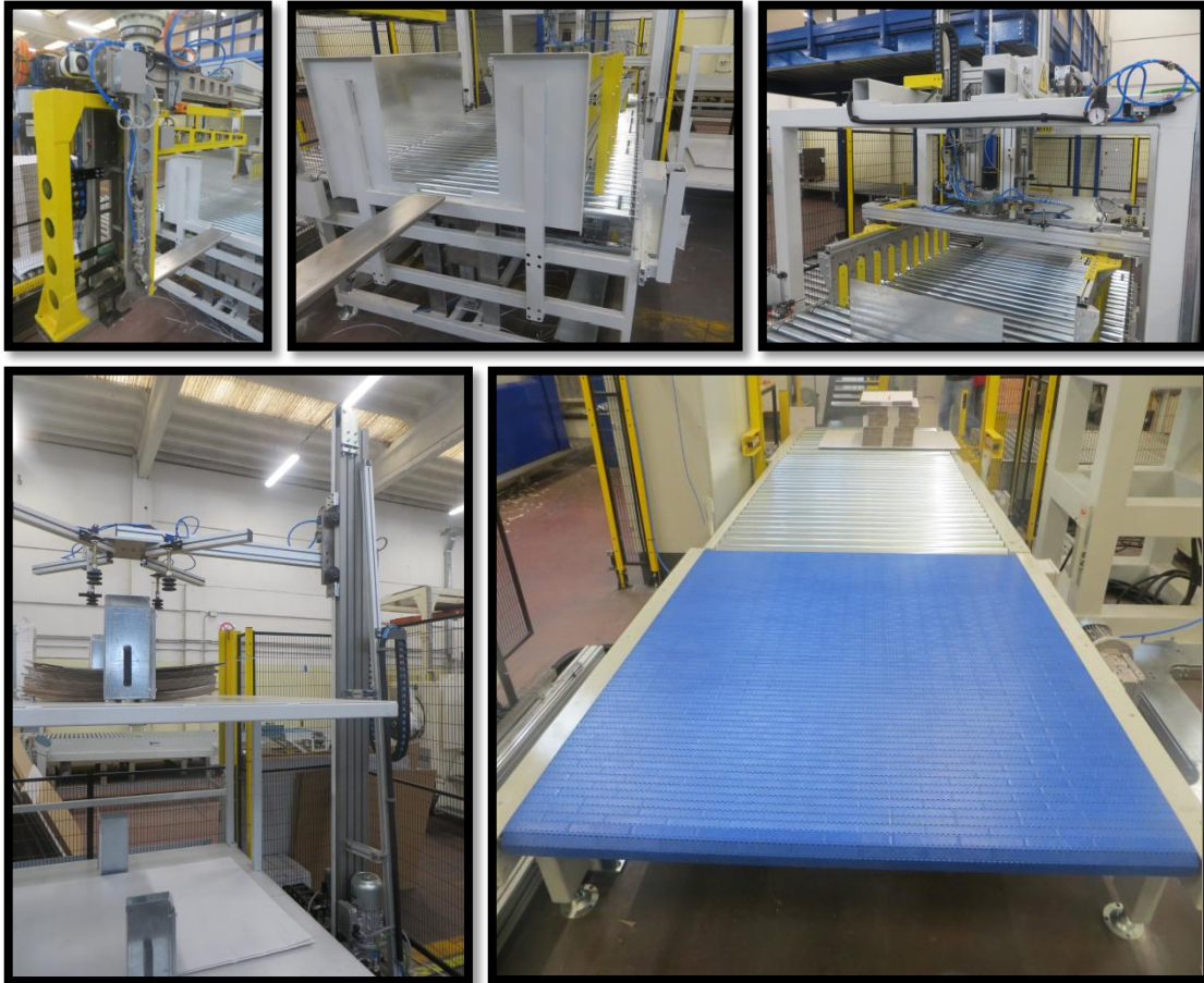
Slika 11 Hvataljka za pakete, uređaj za centriranje paketa i uređaj za udvostručavanje paketa (slike s lijeva na desno, gornji red); uređaj za osnovne listove i isponu i područje odlaganja (slike s lijeva na desno, donji red)
