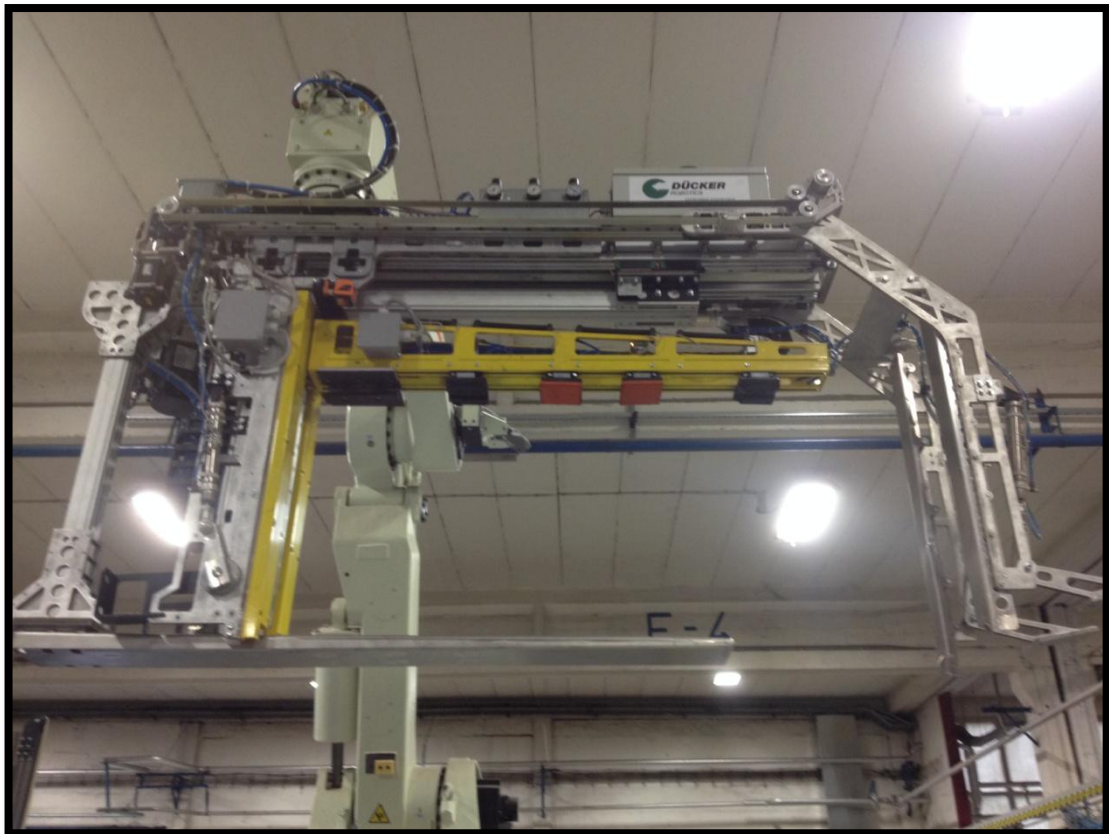
Slika 9 Ulagači robot PAL FFG II
