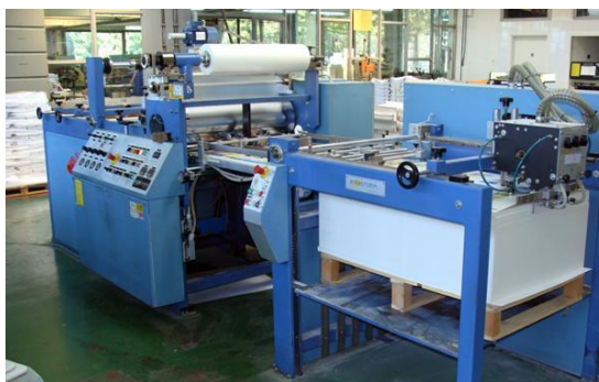
Slika 20. Stroj za plastificiranje knjižnih araka
