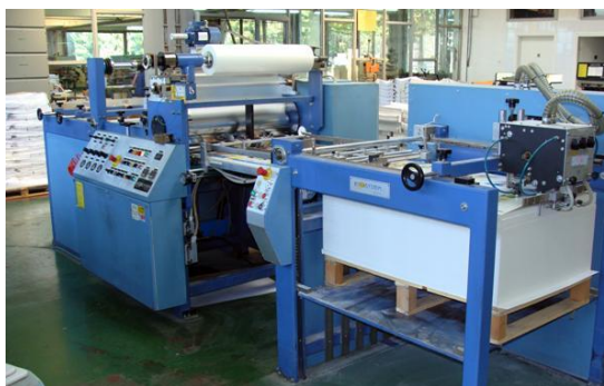
Slika 20. Stroj za plastificiranje knjižnih araka
