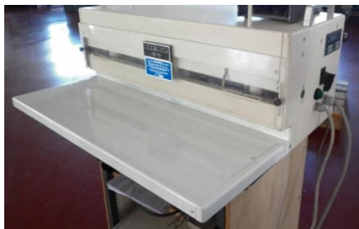
Slika 26. Stroj za spiralni uvez
