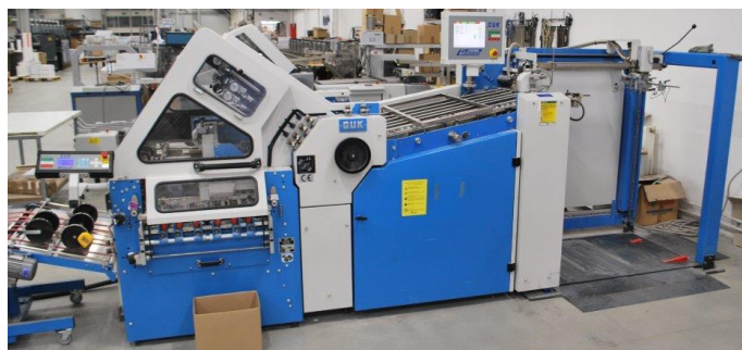
Slika 14. Stroj za savijanje tiskovnih podloga - Savijačica
