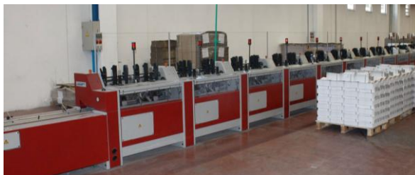
Slika 16. Stroj za sabiranje knjižnih araka u knjižni blok - Sabiračica
