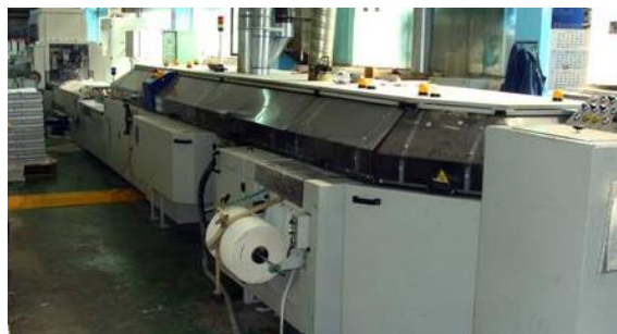
Slika 24. Kolbus linija za lijepljenje knjižnog bloka i stavljanje korica sa tunelom za sušenje
