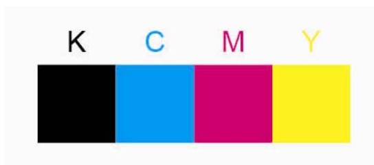
Slika 14. Mjerna polja za kontrolu gustoće obojenja u tisku
