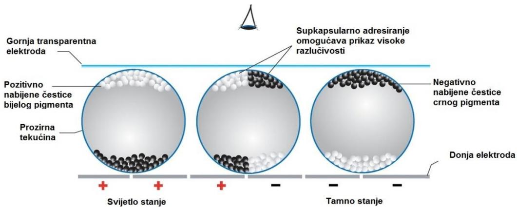
Slika 10 - Princip rada e-ink ekran-a, ecti.cz (2016)
