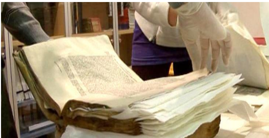
Slika 22: Postupak sušenja ulaganjem papirnih ručnika između mokrih listova
