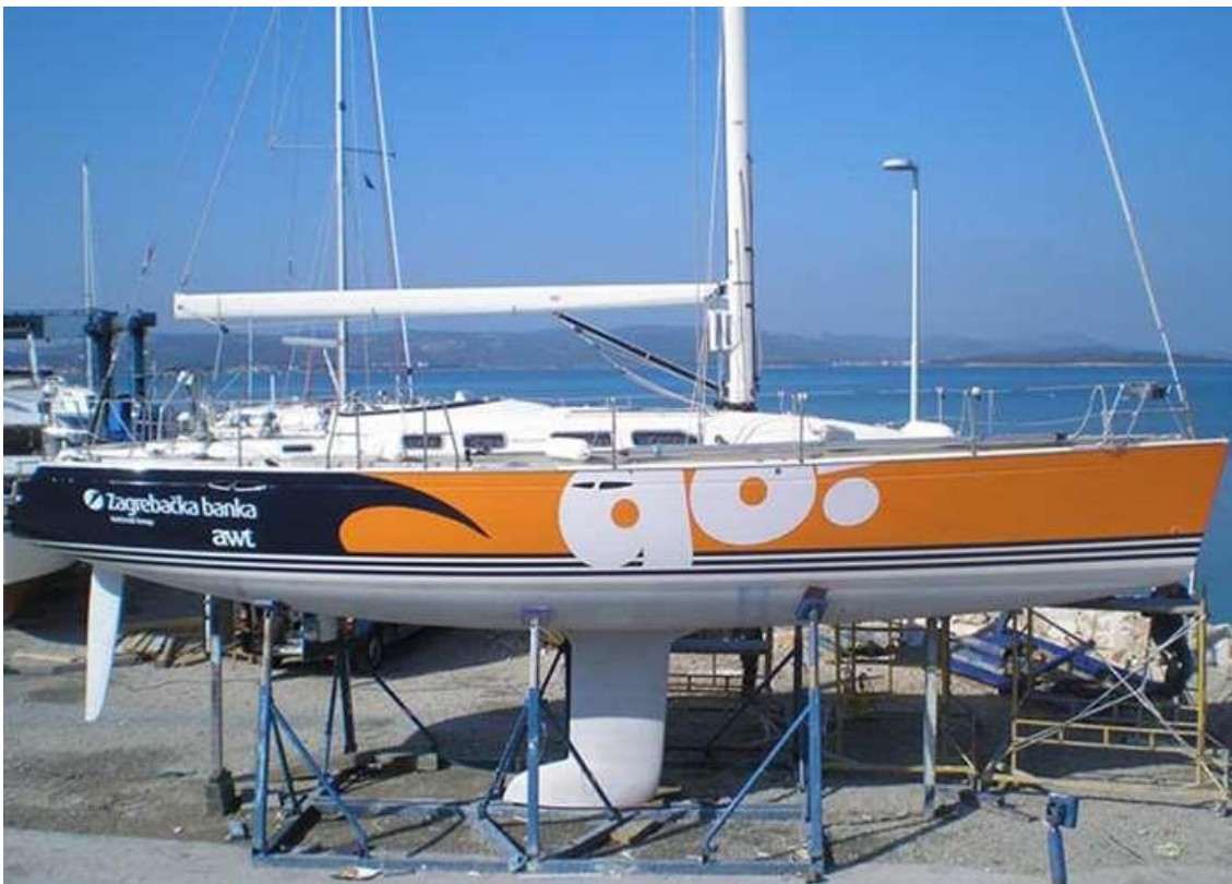
Slika 3. Primjer plovila obloženog u otisnutu foliju
