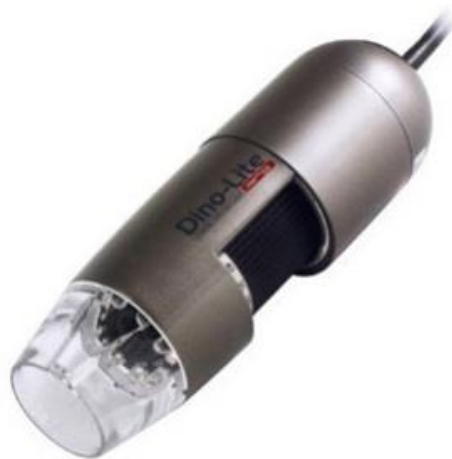
Slika 35. Mikroskop DinoLite Pro
