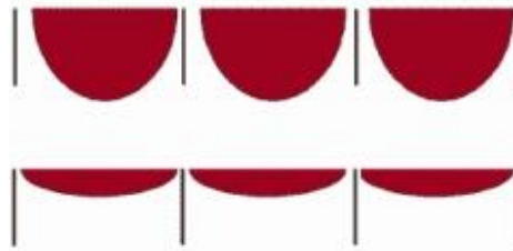
Slika 11. Prikaz ćelije sa većom i manjom zapreminom boje (volumen) [7]
