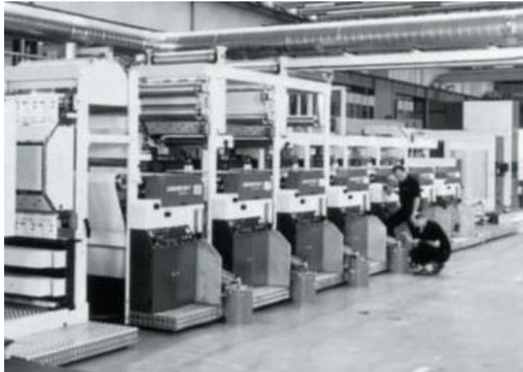
Slika 4. Rezervoari s bojilom smješteni uz tiskovne jedinice rotacije Lemanic 82 F ( ***http://slideplayer.hu/slide/2839032/ )
