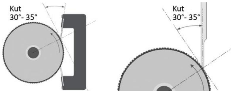
*Slika 5. Kut oštice odstranjivača bojila prema aniloks valjku kod dva različita sustava za obojenje*
