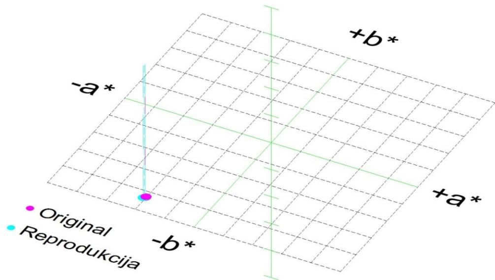
Slika 9. Prikaz CIE  $L^*a^*b^*$  vrijednosti originala i reprodukcije za boju Process Cyan C UV 259 - Kefir light - sva tri mjerena
