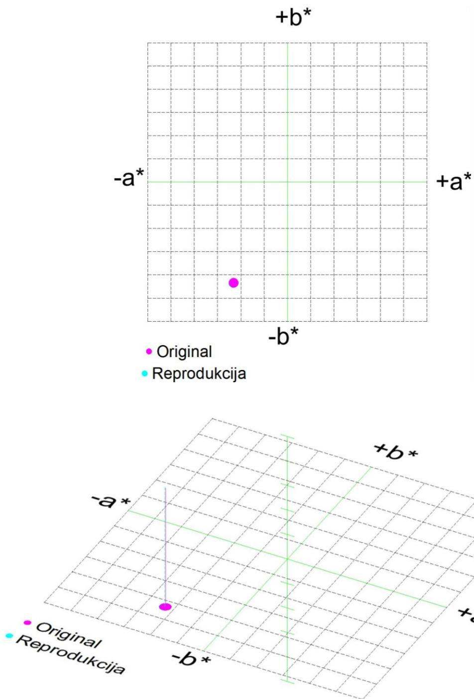
Slika 6. Prikaz CIE L\*a\*b\* vrijednosti originala i reprodukcije za boju Process Cyan C UV 259 - Kefir light - 1.mjerjenje
