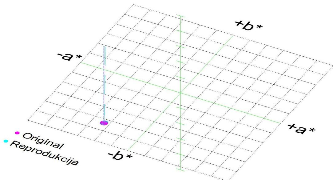
Slika 19. Prikaz CIE  $L^*a^*b^*$  vrijednosti originala i reprodukcije za boju Process Cyan C UV 259 - Freska voćni jogurt jagoda - sva tri mjerena
