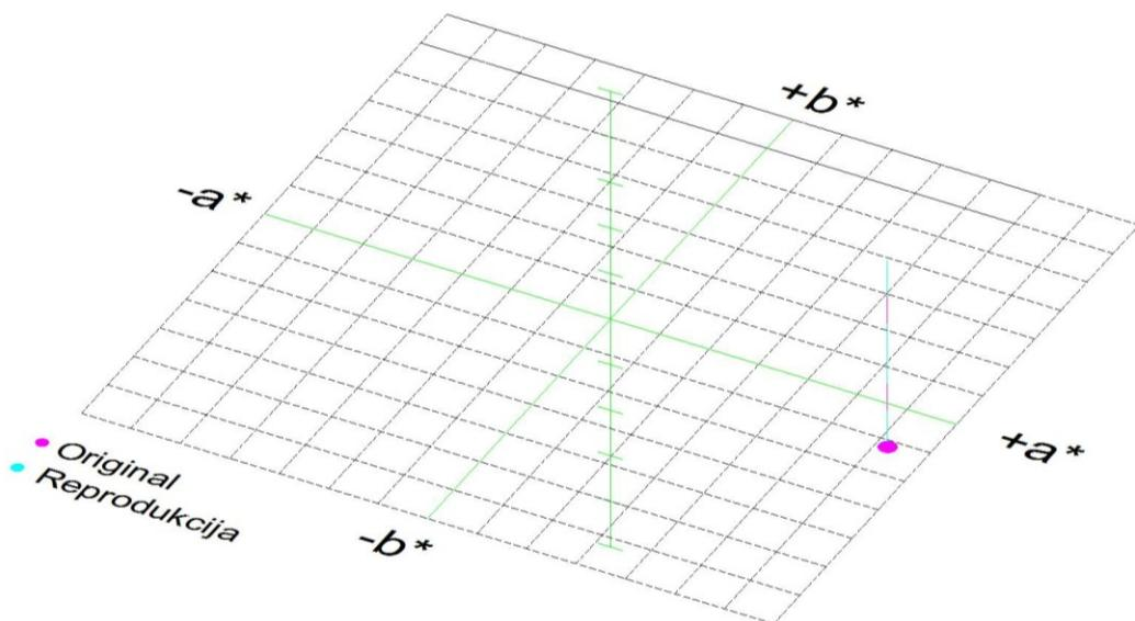
Slika 12. Prikaz CIE L\*a\*b\* vrijednosti originala i reprodukcije za boju Process Magenta C UV 259 - Kefir light - 3. Mjerenje
