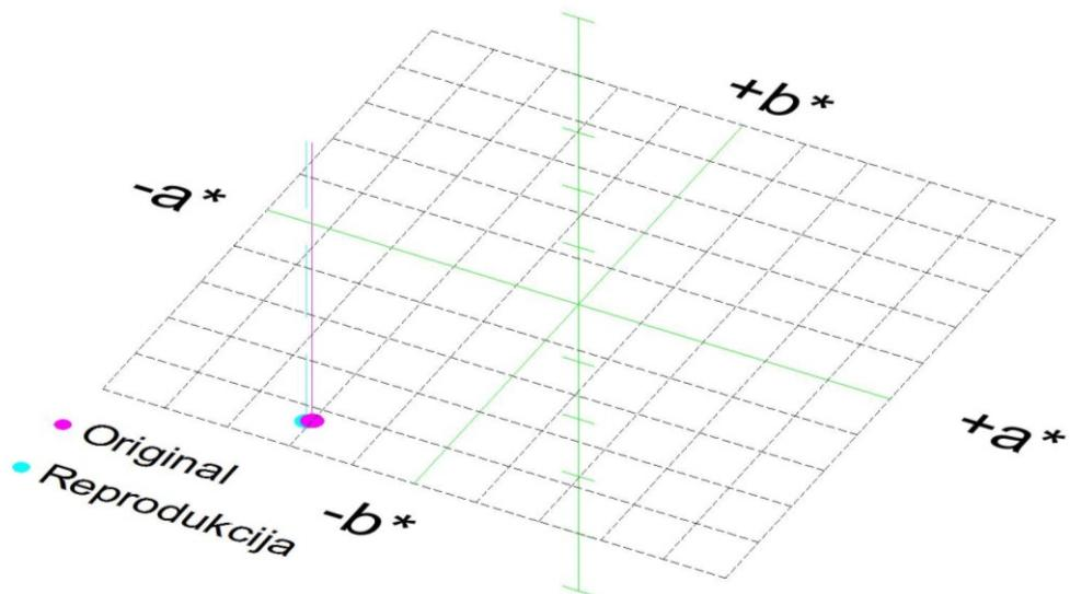
Slika 8. Prikaz CIE L\*a\*b\* vrijednosti originala i reprodukcije za boju Process Cyan C UV 259 - Kefir light - 3. mjerjenje
