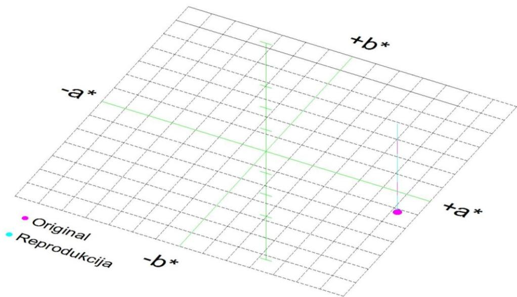
Slika10. Prikaz CIE L\*a\*b\* vrijednosti originala i reprodukcije za boju Process Magenta C UV 259 - Kefir light - 1.mjerenje
