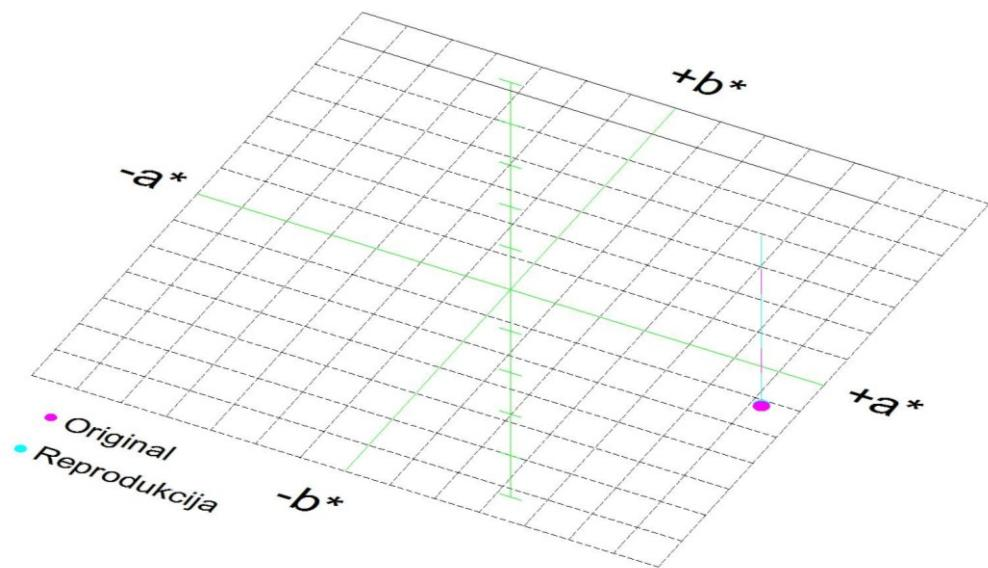
Slika 13. Prikaz CIE  $L^*a^*b^*$  vrijednosti originala i reprodukcije za boju Process Magenta C UV 259 - Kefir light - sva tri mjerena
