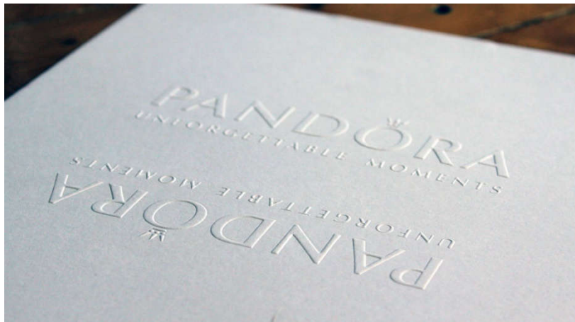
Slika19 - otisak dobiven slijepim tiskom Izvor: http://tabitha.hr/print-i-tisak/slijepi-tisak/
