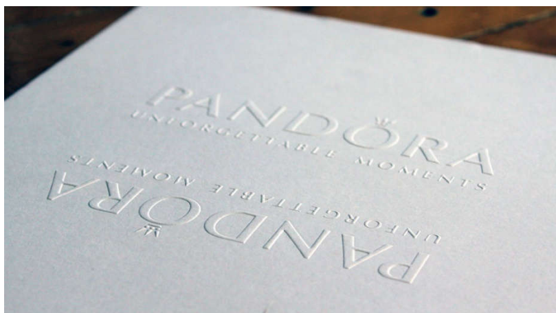
Slika19 - otisak dobiven slijepim tiskom Izvor: http://tabitha.hr/print-i-tisak/slijepi-tisak/
