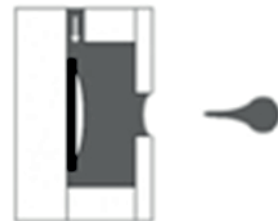
Slika 21. Formiranje kapljice tehnologijom termalnog Inkjeta
