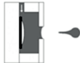
Slika 21. Formiranje kapljice tehnologijom termalnog Inkjeta
