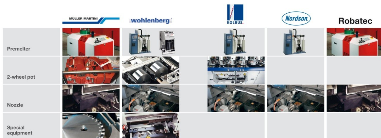
Slika 8: Uređaji za nanošenje PUR ljepila [22]
