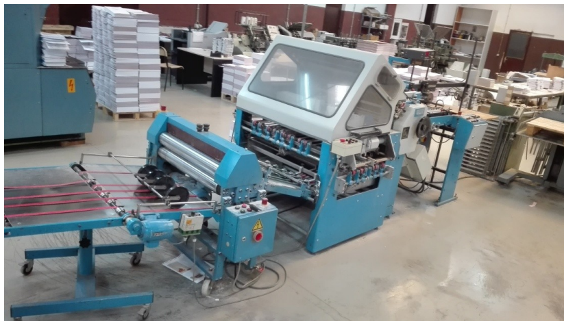
Slika 20. Stroj za savijanje tiskovnih araka GUK 72/4 KTL
