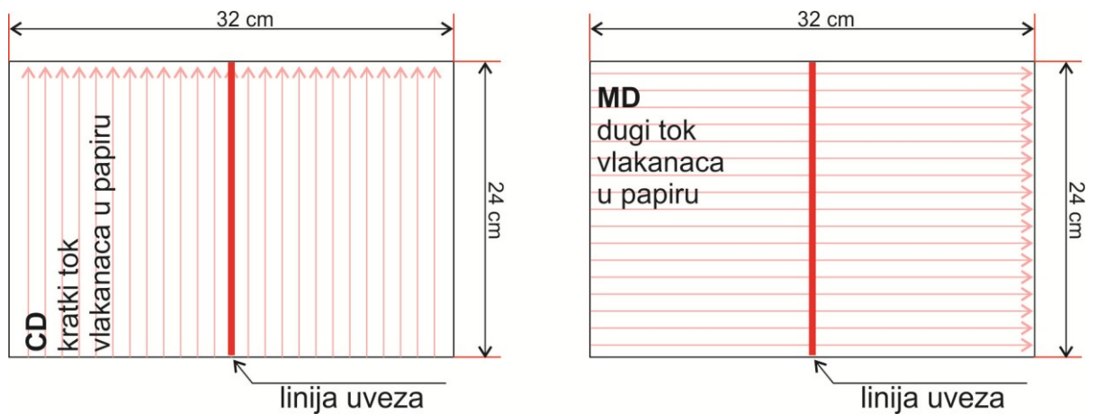
Slika 25. Promatranje toka vlaknaca u papiru kod mjerenja Drap faktora
