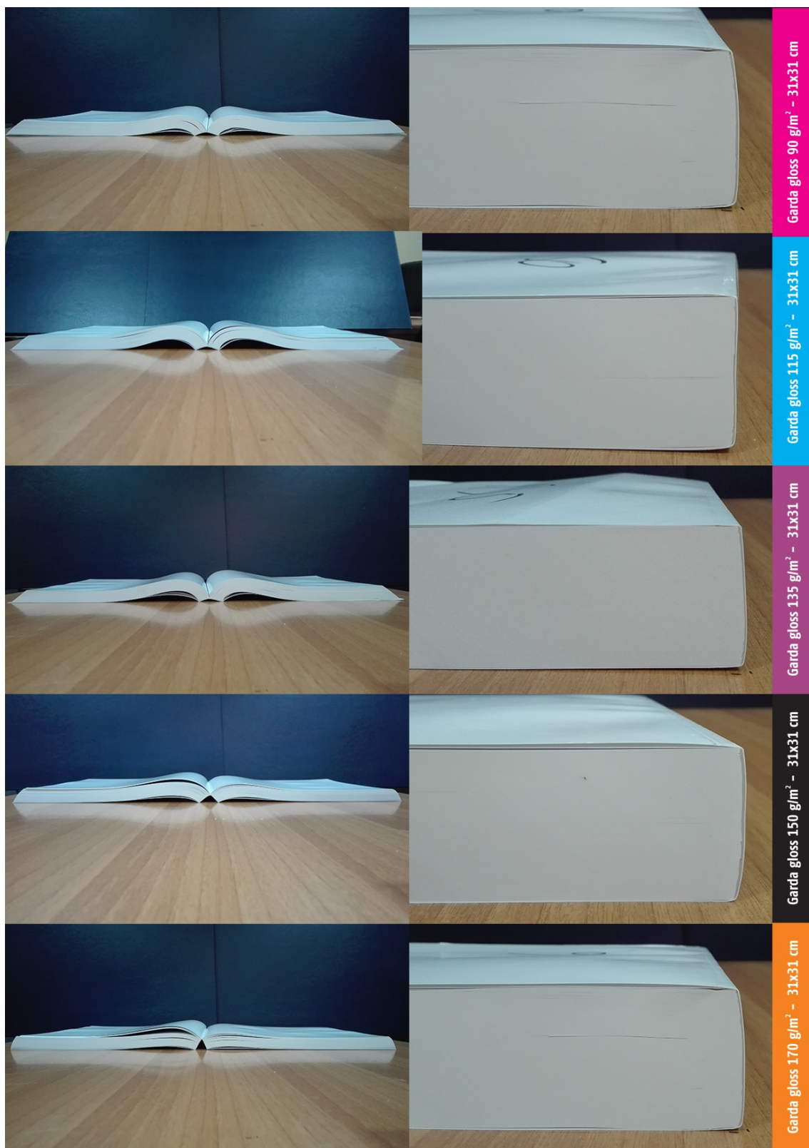
Slika 27. Knjige formata 31x31 cm, izrađena od papira garda gloss 90 g/m 2 , 115 g/m 2 , 135 g/m 2 , 150 g/m 2 , 170 g/m 2 , prikaz otvaranja knjige i deformacije hrpta
