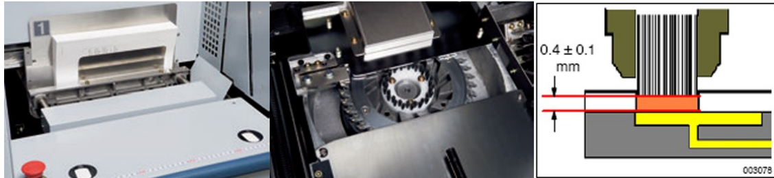
Slika 15: Prikaz uređaja za transport knjižnog blok, uređaja za piljenje i hrapavljenje hrbta sa četkama i usisavačem, dizna za nanošenje ljepila na hrbat
