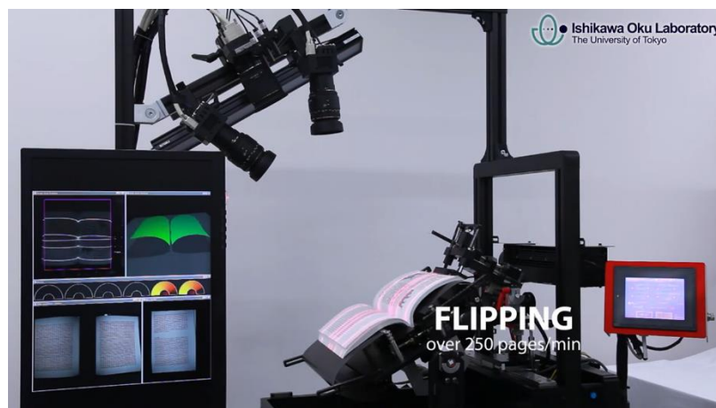
Slika 6. Eksperimentalni OCR sustav sa brzinom okretanja stranica od 250 u minuti
