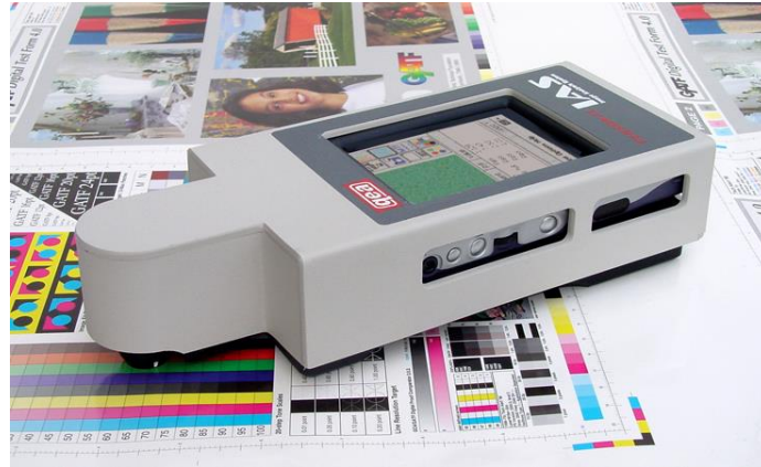
Slika 31. Uređaj za slikovnu analizu QEA Personal IAS (Izvor: http://mail.qea.com/upload/photos/products/1158672685225189_big.jpg )
