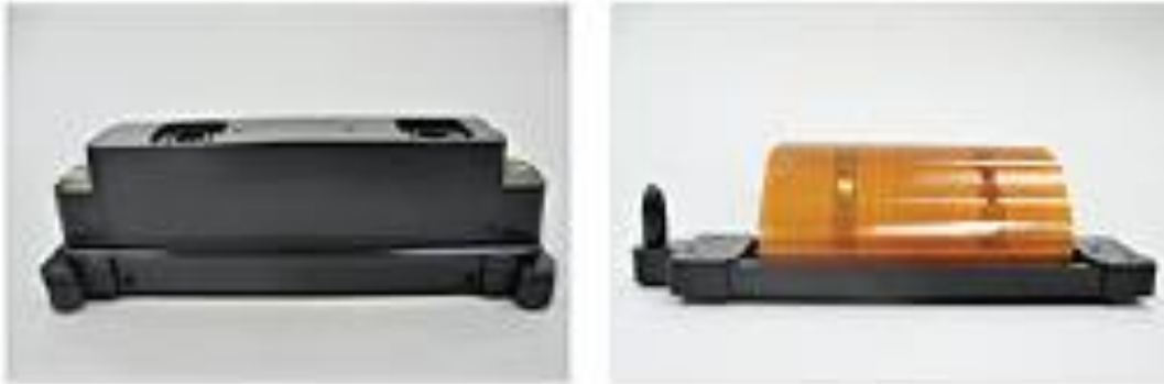
Slika 27. Samsung SemJet industrijska piezoelektrična ispisna glava: sa maskom (lijevo, bez maske (desno) (Izvor: http://www.vcesolutions.com/wp-content/uploads/2014/09/Inkjet-Printhead-Characteristics-Application-Requirements.pdf )
