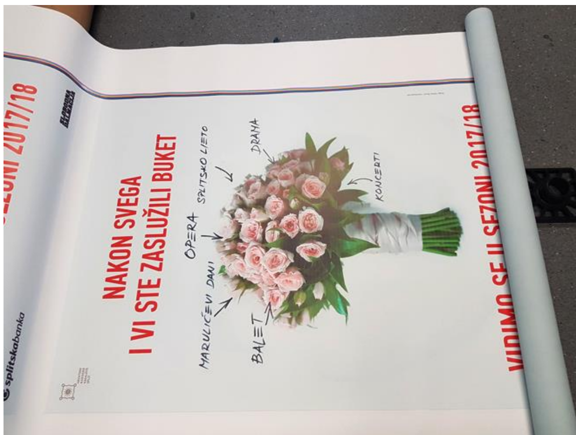
Sl. 53 Ista ta priprema za plakat B0 printana na TECKWIN solventnom printeru na materijalu Blueback. Boje su nezasićene i slabo kontrastne. Na ovaj printer sve pripreme moraju biti u CMYK-u jer ako greškom pustimo RGB u print, mada Caldera RIP ima konverziju u CMYK prostor boja vrlo loše to odradi zbog svojih profila koji nisu napravljeni kako treba.
