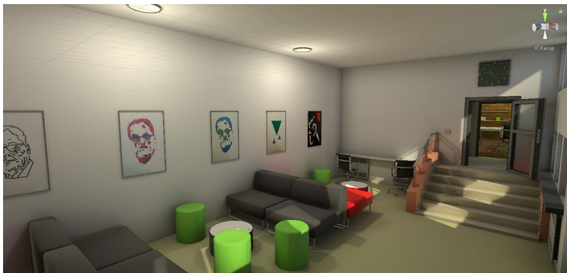
Slika 20. Scena s postavljenim komponentama za svjetlost i izračunatom globalnom iluminacijom i sjenama.
