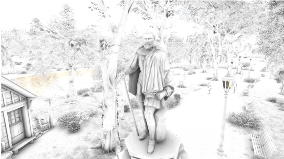
Slika 3. Scena iz računalne igre Assassin's Creed: Syndicate s isključenim bojama i vidljivim samo SSAO efektom.
