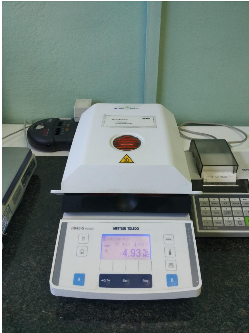
Slika 22: Digitalna automaska vaga/halogeni vlagomjer
