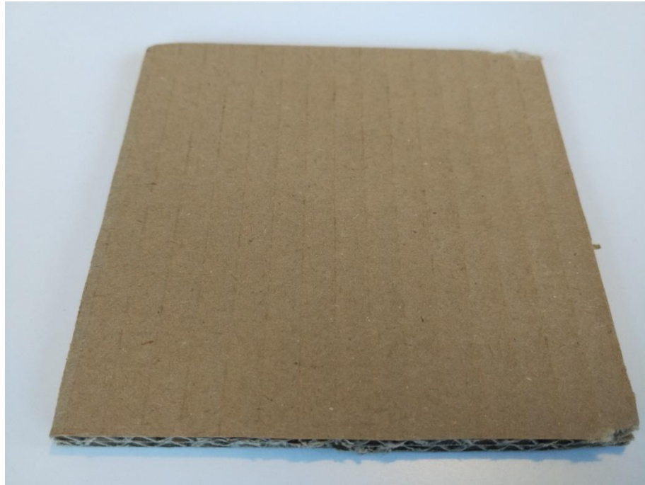
Slika 23: Uzorak valovite ljepenke za određivanje gramature
