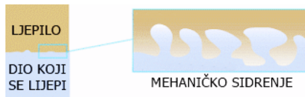
Slika 2. Prikaz mehaničkog sidrenja
